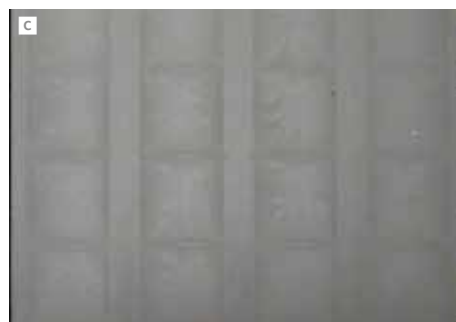
13 Основные дефекты при герметизации: А — коробление; В — неполная герметизация; С — косметический дефект — контрастные области над кристаллом
